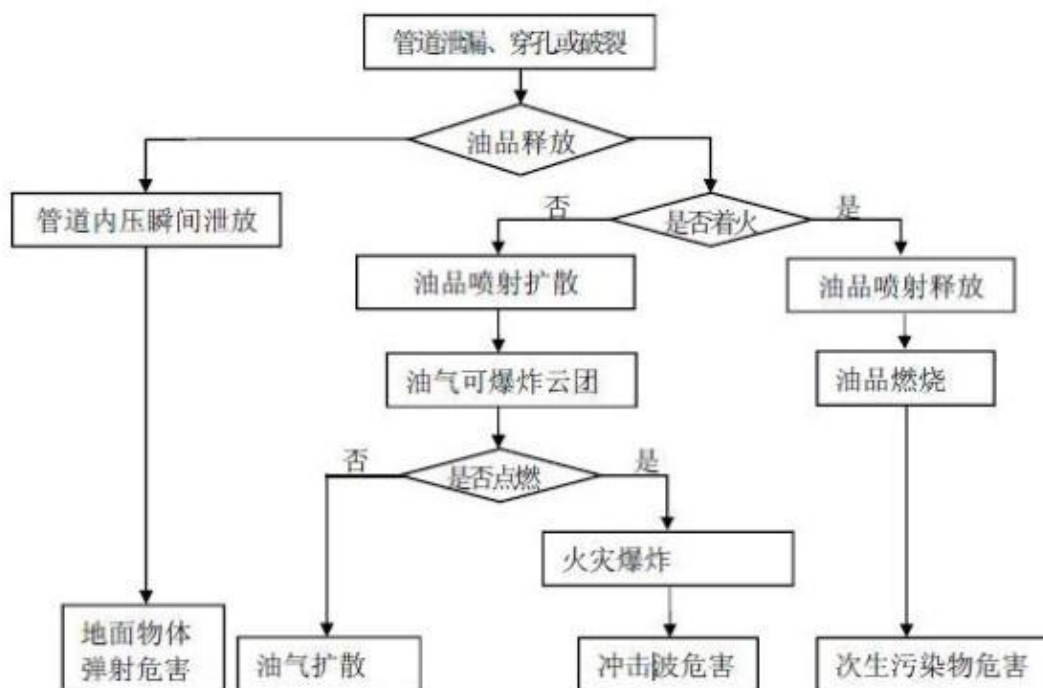
图 7.4-1 管道事故树分析示意图
